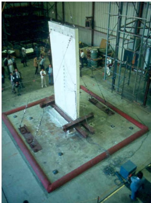
Bild 14 Wand aus bewehrtem Mauerwerk auf dem Erdbeben-Rütteltisch der University of California, Berkeley
